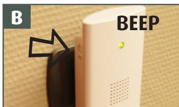
Appuyez 3 secondes sur la touche de sélection du canal sur le côté du carillon. Le carillon émet un signal monotone. Il est prêt à mémoriser un second signal.
