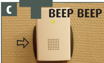
Introduisez le carillon dans la prise. Le dispositif produit alors un signal à deux tons. Cela signifie que l'unité est prête à recevoir un code numérique.
